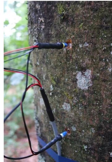
Mis en place de capteurs de flux de sève en 2022
